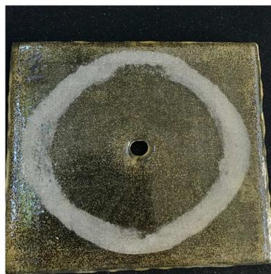
На графике (слева) представлен результат абразивного воздействия на S-COMPOSIT CRYSTAL, где ось «X» - это количество циклов (каждый цикл состоит из 100 оборотов истирающего круга «Calibrade H -18»), ось «Y» – общая потеря массы (мг) образца при абразивном воздействии.
